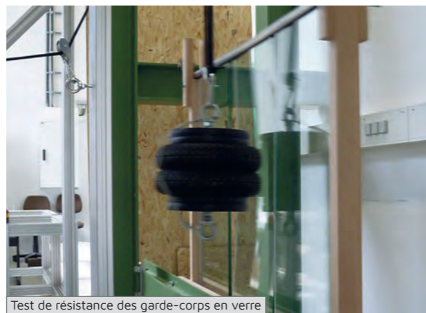
Test de résistance des garde-corps en verre
